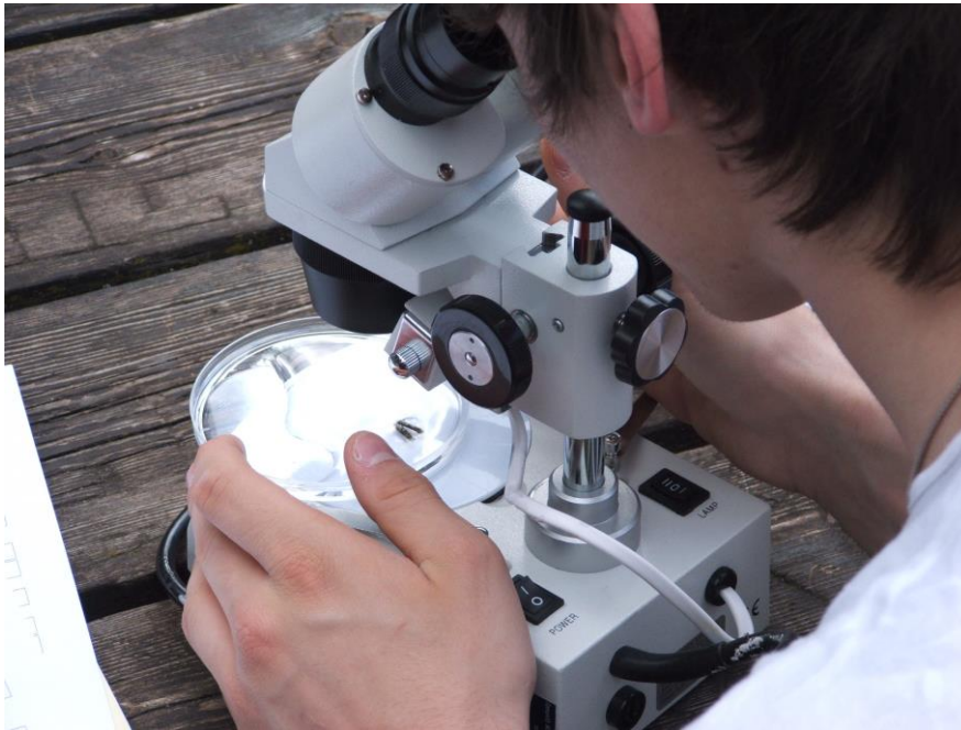
Osservazione al microscopio per la determinazione delle specie di bioindicatori mediante l'utilizzo di chiavi dicotomiche (Vezza). (immagine sopra e sotto)
